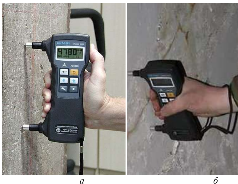
Рисунок 3.3 - Измерение времени прохождения ультразвука: а - по сплошному материалу около трещины, б - через трещину
