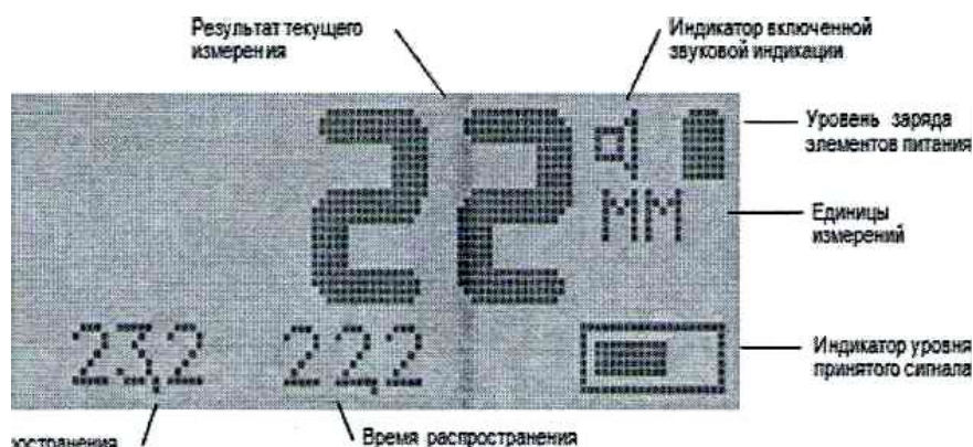
Рисунок 3.2 - Вид экрана в режиме измерений глубины трещины
